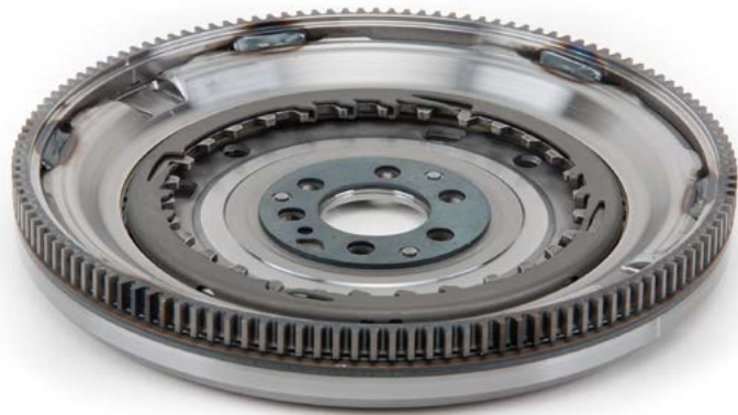
Kuva 1: Käynnistimen hammaskehän hampaiden määrän täytyy uudessa osassa olla sama kuin vanhassa
