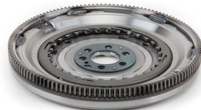
1. ábra: Az új indító fogaskoszorú fogszámának meg kell egyeznie a réginek a fogszámával
