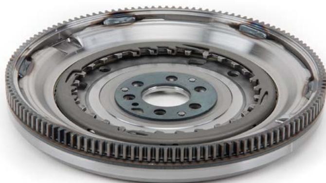
Bild 1: Antalet kuggar på kuggkransen hos den nya detaljen skall vara samma som antalet på den gamla
