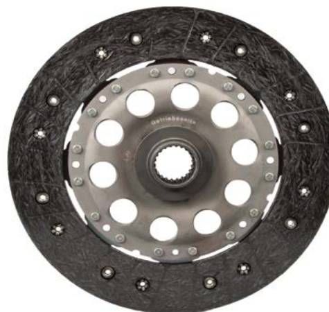
Снимка 2: Фрикционен диск за първоначално вграждане (диаметър 240 мм)
