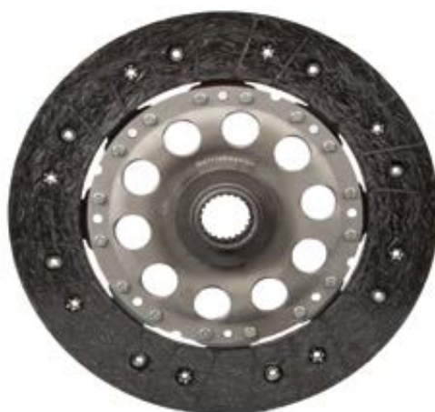
איור 2: דיסק המצמד המקורי אשר סופק בעבר (בעל קוטר של 240 מ"מ)
