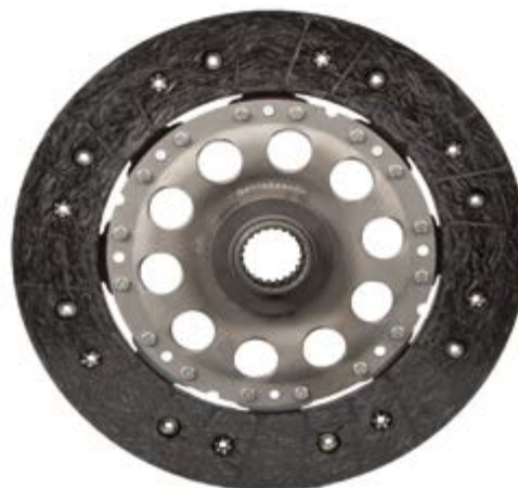
Foto 2: Tarcza sprzęgła z pierwszego montażu OE (średnica 240 mm)
