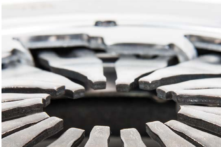
Снимка 1: Отклонение на палците на диафрагмената пружина на демонтиран съединител
