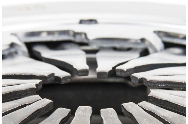
Bild 1: Versatz der Tellerfederzungen bei demontierter Kupplung
