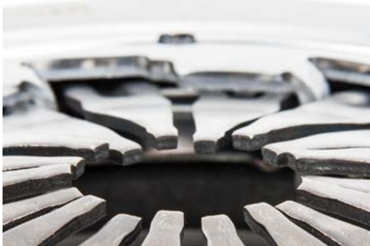
Εικόνα 1: Κακή ευθυγράμμιση χτενιών σε αποσυναρμολογημένο συμπλέκτη
