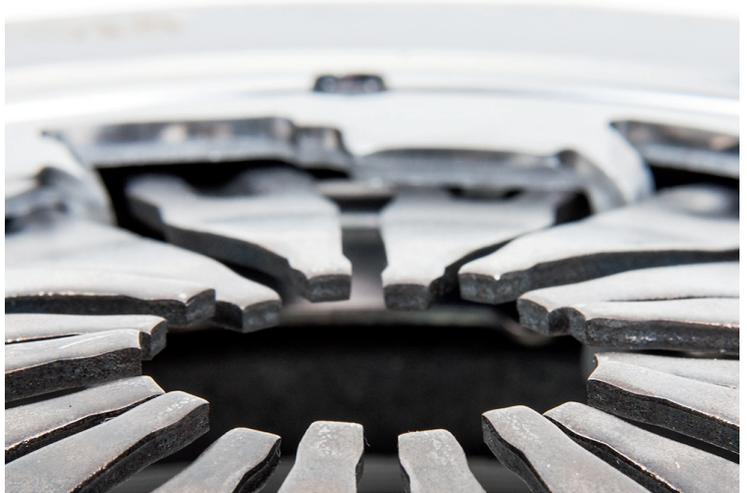
Fig. 1: Alineación de las lengüetas del diafragma en embrague desmontado
