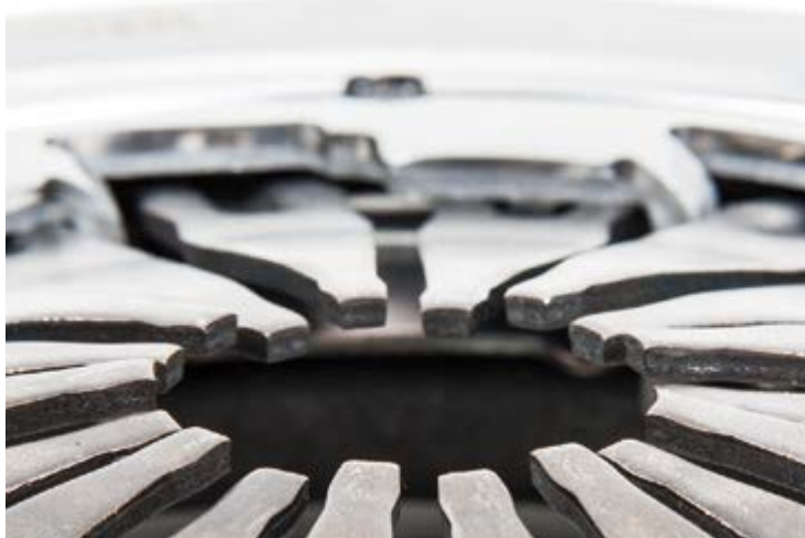
Рисунок 1: Неравномерность высоты пальцев диафрагменной пружины неустановленного сцепления
