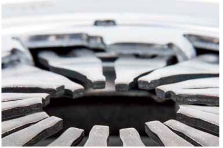
Şekil 1: Demonte edilmiş bir debriyaj üzerinde diyafram yay parmaklarının eşit yükseklikte olmaması
