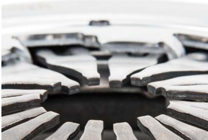
Рисунок 1: Неравномерность высоты пальцев диафрагменной пружины неустановленного сцепления
