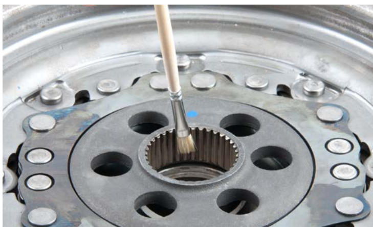
Снимка 1: Определено количество грес трябва да се приложи върху вътрешните шлицы на DMF при всяка подмяна
