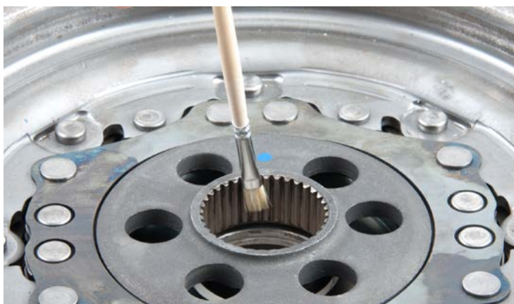
Obrázek 1: Vnitřní ozubení dvouhmotového setrvačnicku by mělo být při každé opravě mírně namaženo
