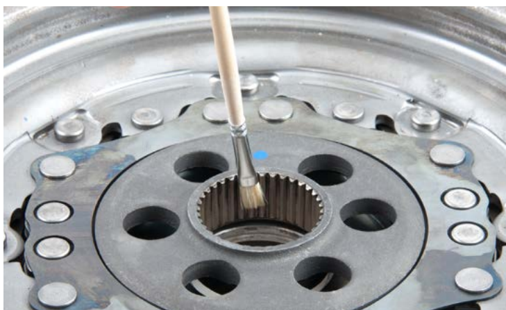
Εικόνα 1: Θα πρέπει να εφαρμόζεται μικρή ποσότητα γράσου στο καρέ του βολάν, σε κάθε επέμβαση που πραγματοποιείται σε αυτό
