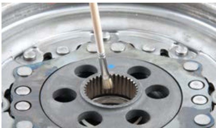
Kuva 1: Kaksoismassavauhtipyörän sisäpuolinen hammastus pitäisi voidella kevyesti jokaisen korjauksen yhteydessä
