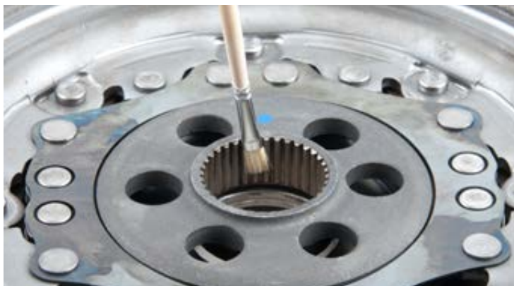
איור 1: יש לספק כמות גריז על שיני ההזחה הפנימיות של גלגל התנופה כפול המסה (DMF) בכל פעם שמבצעים תיקון כלשהו ומסירים אותו
