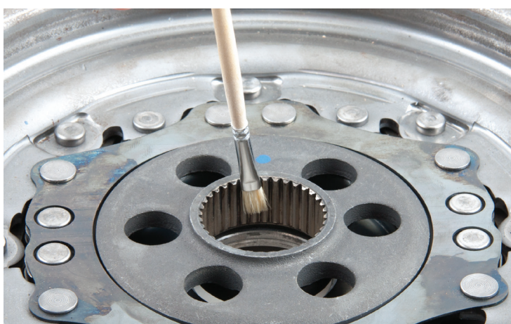
Fig.1: De binnenvtanding van het tweedelig vliegwiel moet bij elke reparatie licht worden ingevet
