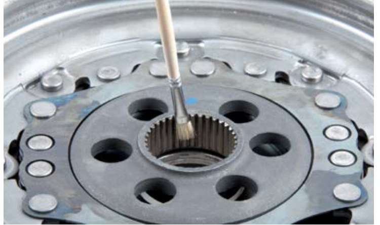
Resim 1: Her bakım yapıldığında çift kütleli volanın iç frezesine biraz yağ sürülmelidir.
