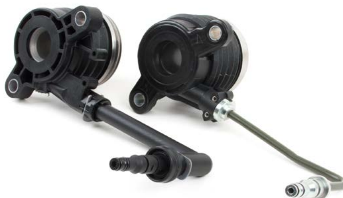
Obrázek 1: Centrální vypínací mechanismus s malými hydraulickými přípojkami
