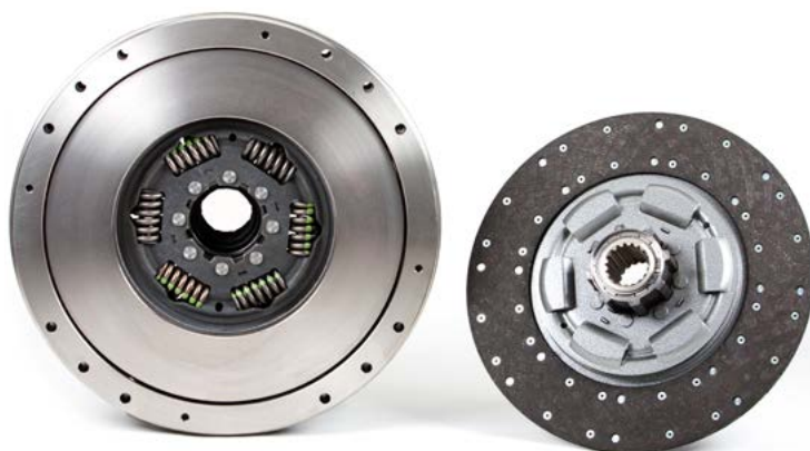
Εικόνα 3: Παράδειγμα διπλού συμπλέκτη, με διαφοροποιημένο σχεδιασμό του κέντρου του
