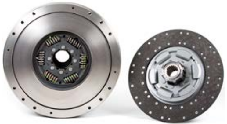
Kuva 3: Esimerkki kaksilevyisestä kytkimestä napojen erilaisella rakenteella
