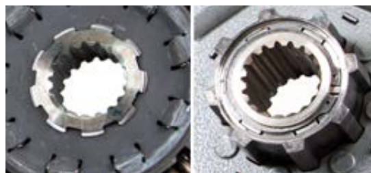
איור 1: טבור מתוצרת LuK (שמאל), טבור מתוצרת חברה אחרת (ימין)
