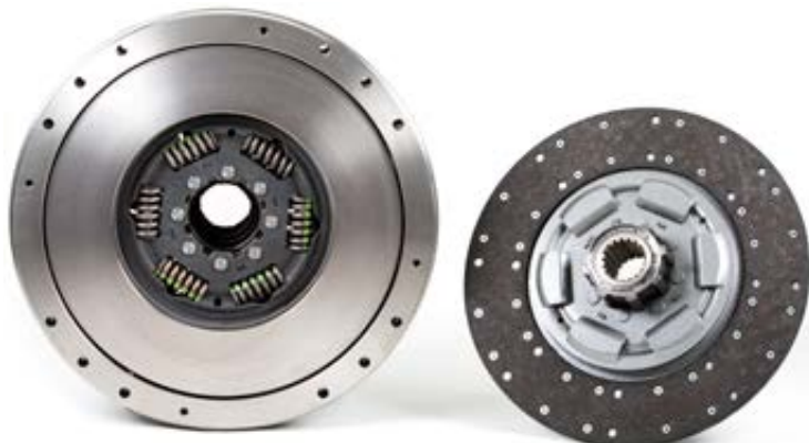
איור 3: דוגמה של מצמד בעל דיסק כפול בעל תכנון ועיצוב טבור שונה.
