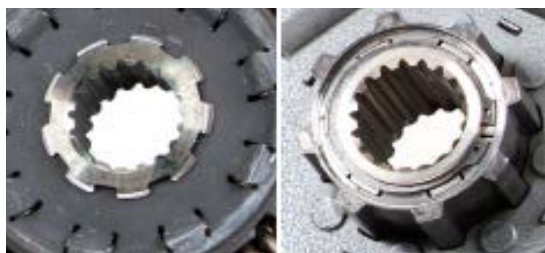
Slika 1: LuK glavina (lijevo) i glavina drugog proizvođača (desno)
