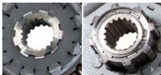
Рис. 1: Ступицы LuK (слева), ступицы других производителей (справа)
