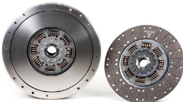
Рис. 2: Двойные диски сцепления LuK с одинаковым профилем шлицевых ступиц
