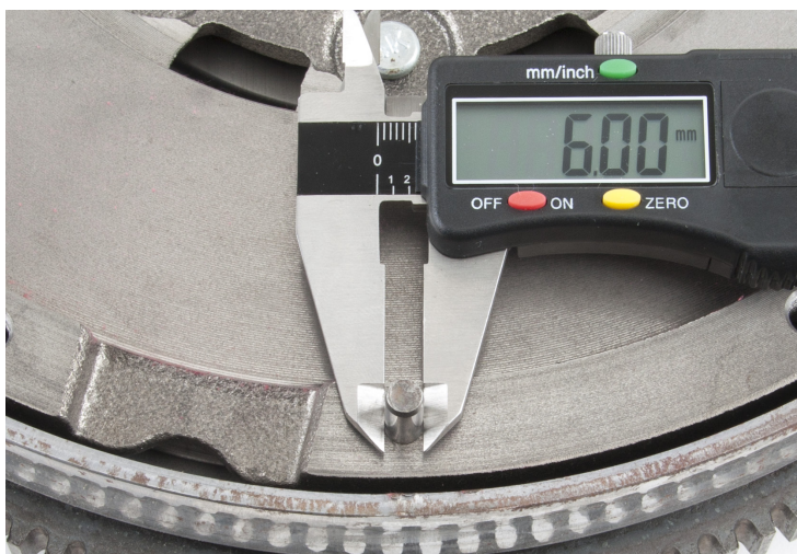
Снимка 1: Измерване на диаметъра на центриращия щифт
