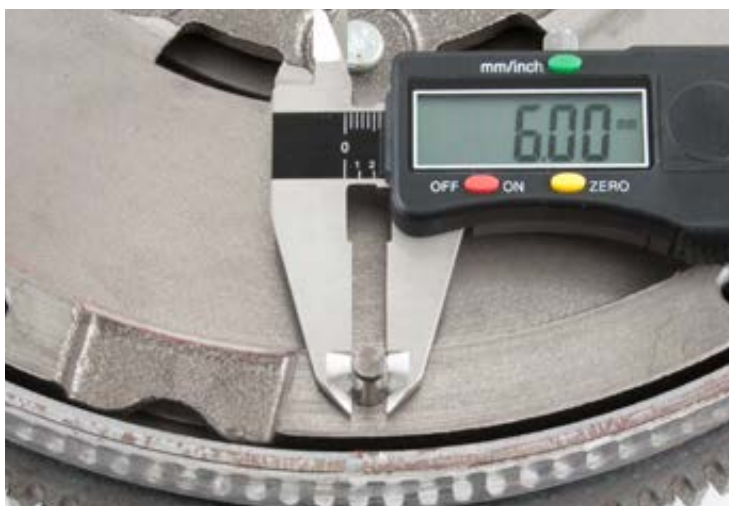
Εικόνα 1: Μέτρηση διαμέτρου πείρου κεντραρίσματος
