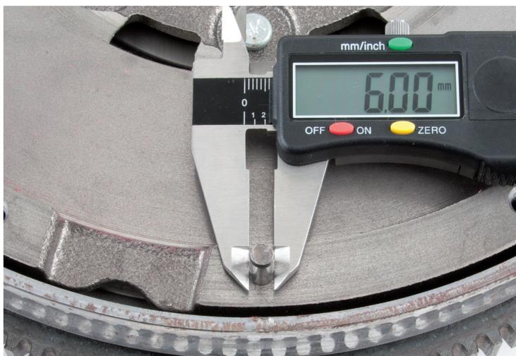
Photo 1 : Mesure du diamètre du téton de centrage
