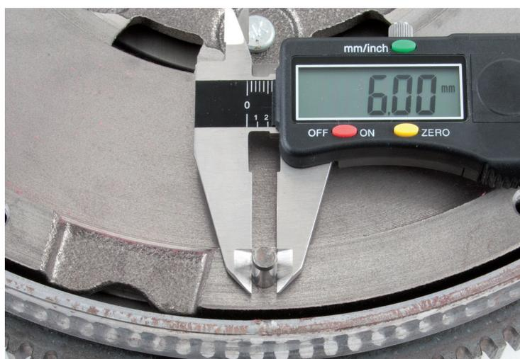
Figura 1: determinazione del diametro dei perni di centraggio
