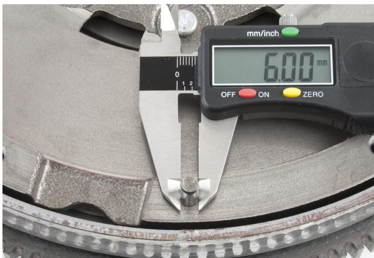
Рис. 1: Измерение диаметра центровочной шпильки
