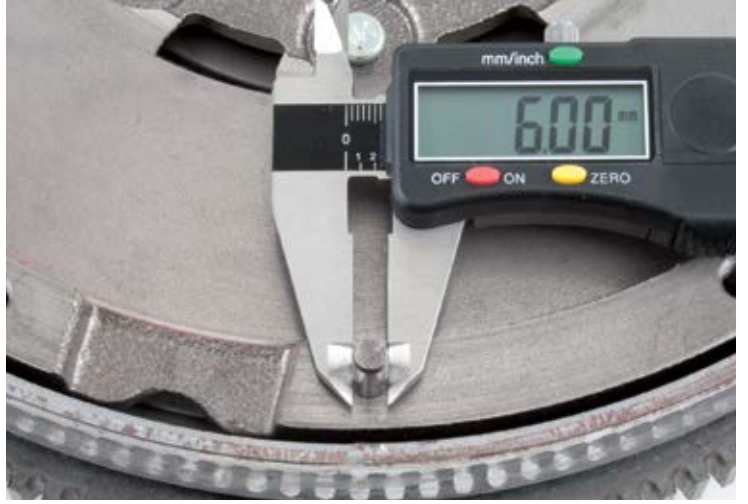
Resim 1: Debriyaj piminin çapının ölçülmesi
