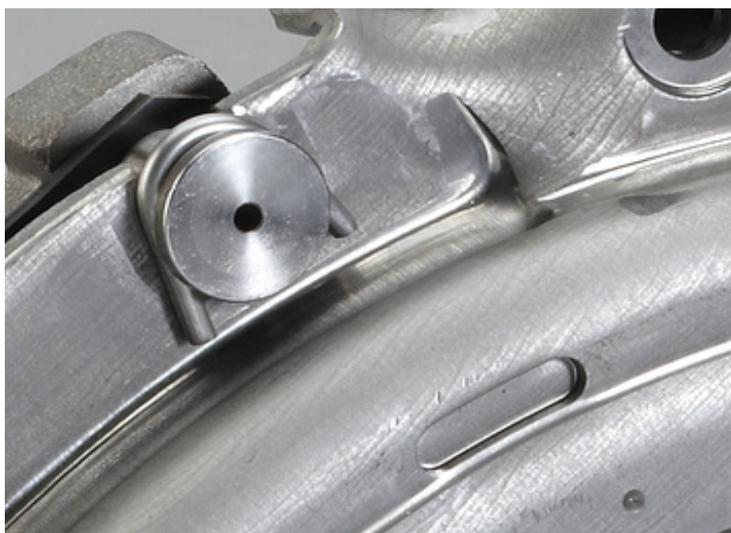
Fig. 2: A fixação de montagem é colocada entre o perno escalonado e a carcaça da embraiagem
