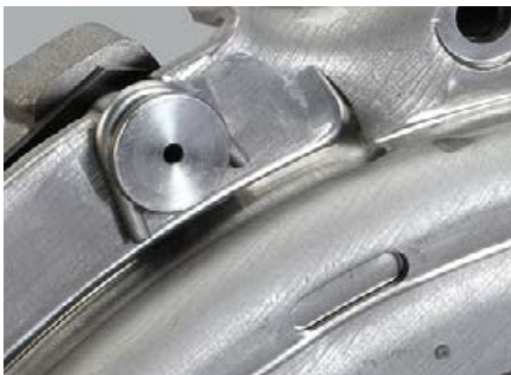
Fig. 2: Clemele de sârmă se montează între știfturile opritoare și carcasa ambreiajului
