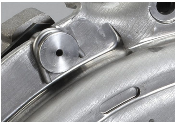
Снимка 2: Телените фиксатори са монтирани между ограничителните щифтове и корпуса на съединителя
