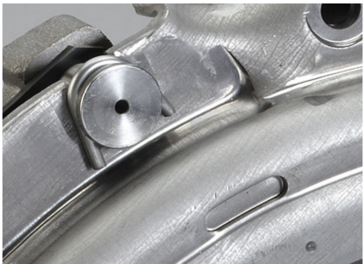
Εικόνα 2: Τα δεματικά είναι τοποθετημένα μεταξύ των τερματικών πείρων και του περιβλήματος συμπλέκτη
