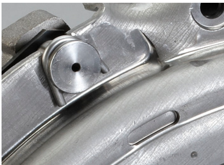
Slika 2: Žičani se profili postavljaju između zatika i kućišta potisne ploče
