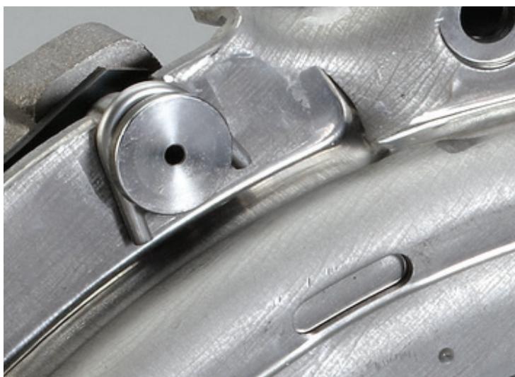
Fig. 2: De montagebeugels worden tussen de getrapte bout en het koppelingshuis geplaatst
