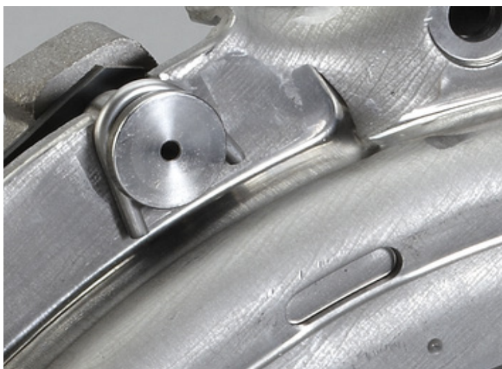
Рис. 2: Проволочные закладные установлены между корпусом сцепления и направляющими ограничителями
