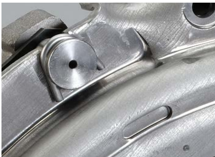
Bild 2: Monteringsbyglarna sätts in mellan stegbultarna och kopplingshuset
