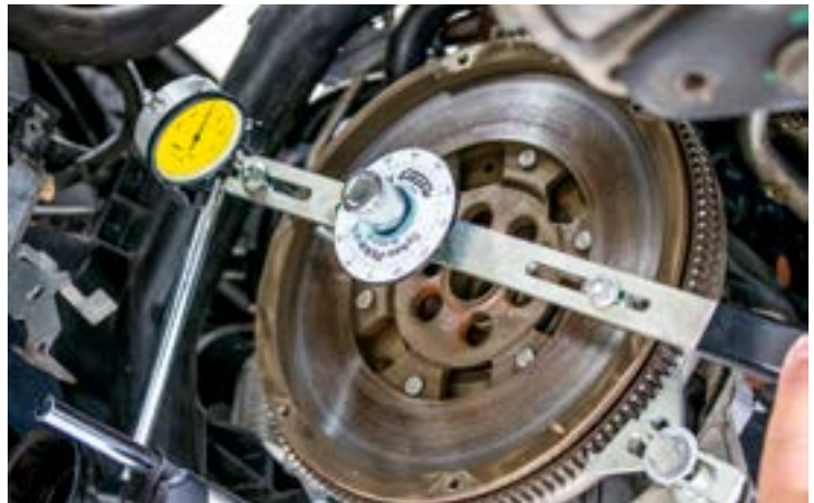
Kaksoismassavauhtipyörän tarkastusväline, tilausnro: 400 0080 10
