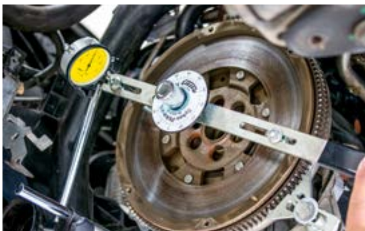
ZMS-vizsgáló szerszám, cikksz.: 400 0080 10
