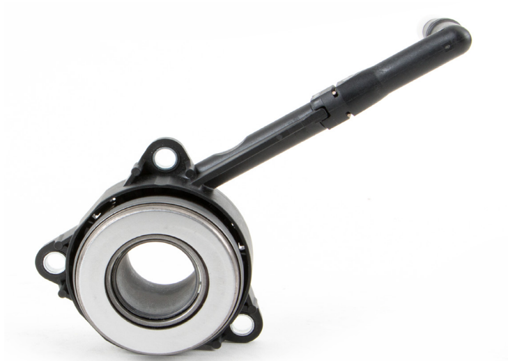
Het hydraulisch druklager moet na een bepaalde periode worden ont lucht
