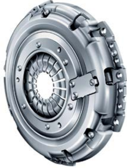
Resim 2: Değiştirilmiş sabitleme halkalı, rampasız kendinden ayarlı baskı
