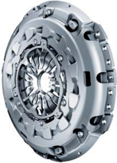
Resim 1: Değiştirilmiş sabitleme halkalı, rampasız kendinden ayarlı baskı
