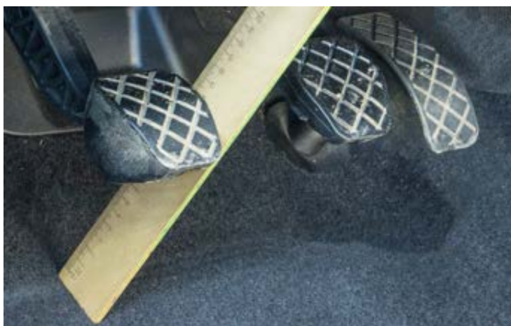
Εικόνα 1: Μετά την αντικατάσταση του συμπλέκτη, ρυθμίστε τον τζόγο του πεντάλ.
