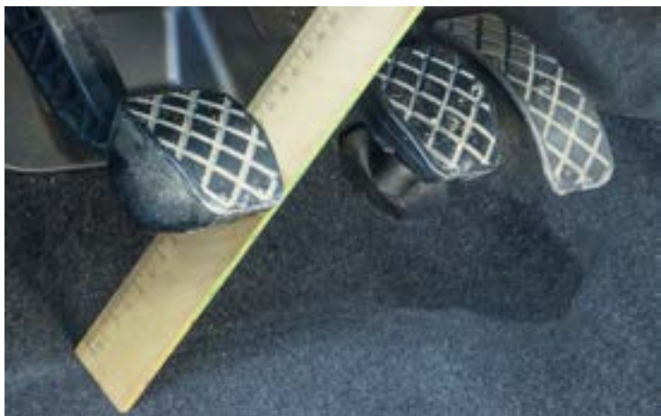
Kuva 1: Kytkimen vaihdon jälkeen on säädettävä polkimen välys
