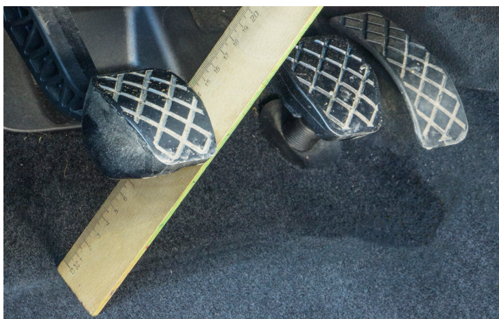
Slika 1: Po ugradnji nove spojke potrebno je provjeriti, a po potrebi i podesiti vrijednost slobodnog hoda pedale.
