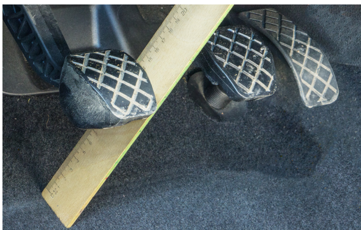
Fig. 1: Na het vervangen van de koppeling moet de pedaalspeling worden ingesteld
