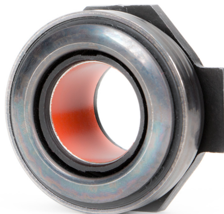
Fig. 3: Druklagers met PTFE-bussen mogen niet van smeermiddel worden voorzien
