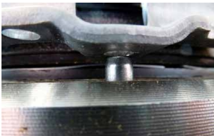
Fig. 1: Știfturile de centrare nu pătrund în orificiile destinate
